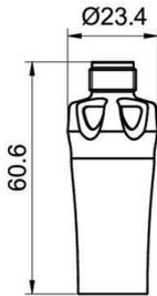
Boîtier avec transmetteur de mesure Dual Channel et connecteur M12-A KingCrown, 4 pôles (avec LED)
