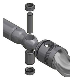
**Maintenance :** La série Diamant DN est conçue pour garantir une maintenance facile en réduisant au minimum le nombre de composants à remplacer. En particulier, les douilles de l'articulation permettent la remise en état de celle-ci sans devoir remplacer les arbres et les rotors. Les coûts de maintenance sont ainsi réduits. Le coût de la machine, si l'on considère l'ensemble de sa vie, s'avère être très compétitif.
